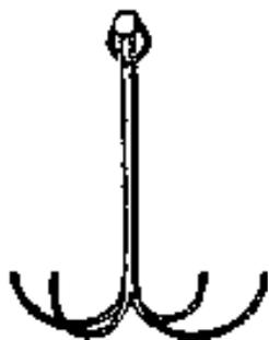
**Способ применения.** С кормы шлюпки опускают на тросе кошку и, волоча ее движением шлюпки, тралят дно.
