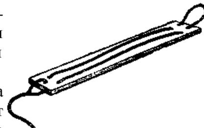
**Правила пользования.** Спасательную доску толкают до места пролома, провалившийся хватается за петлю, подтягивается и влезает на доску. Затем за конец вытаскивают доску вместе с пострадавшим из пролома льда.
